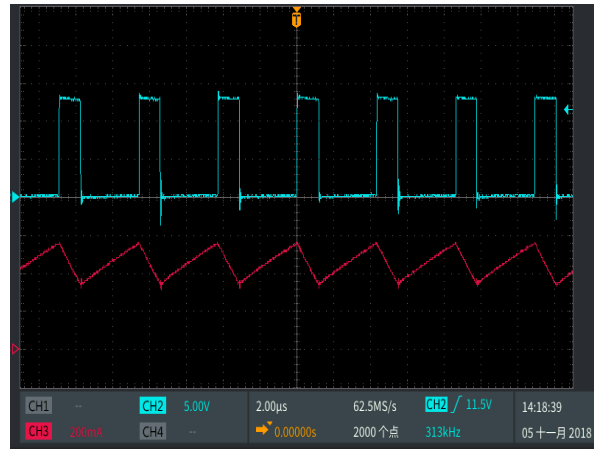
SW 脚与电感电流工作波形
